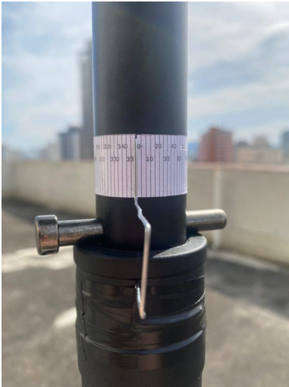
Figura 3: Gabarito utilizado como guia para rotacionar a fonte sonora durante as medições.
